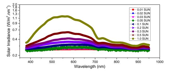
SPECTRAL SOLAR IRRADIANCE OF LSS SOLAR SIMULATOR
